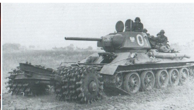
Ci-contre : « La route de la victoire ! » (Koretski, 1942) Celle-ci est désignée par une boussole pointant vers l'ouest... Ci-dessus : Un char T-34 équipé d'un rouleau de déminage PT-3. Ce système de déminage était capable d'endurer une dizaine de détonations avant de devoir être changé. Il fût mis au point et utilisé pour la première fois
