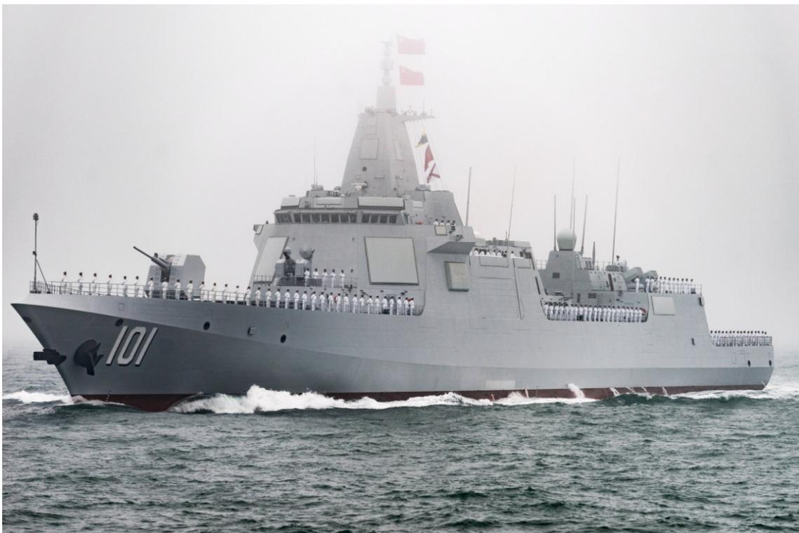
Le destroyer chinois lourd Nanchang, navire de tête de Type 055, est entré en service actif en janvier 2020. Doté du tout dernier RADAR AESA doté d'une portée estimée à 400-500 km, de brouilleurs, de leurres et du dernier CIWS de Type 1130 pour sa défense rapprochée, il est armé de torpilles anti-sous-marines et peut accueillir deux hélicoptères. Son armement principal est constitué d'un système VLS de 112 cellules pouvant recevoir différents types de missiles (missiles de croisière CJ-10 de
